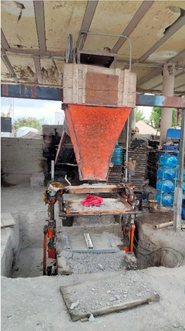
**Figura 1.** Estación de vicompresión de los tabicones con adición de EPS.
