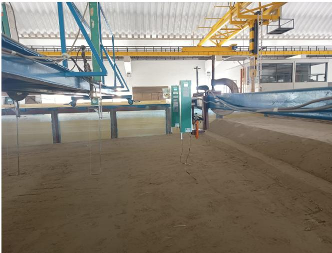
**Figura 4.** Sensores de medición de oleaje colocados durante los ensayos en modelo físico para el registro de las alturas de ola generadas.
