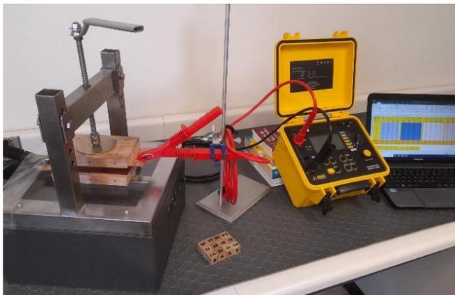
**Figura 3.** Pruebas de resistividad eléctrica.
