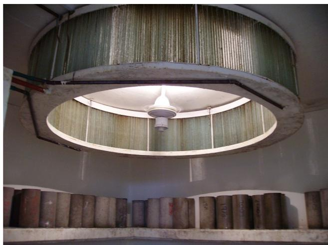
**Figura 3.** Cámara de curado de la Universidad de Guanajuato
