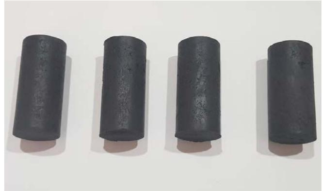
**Figura 1.** Probetas de silicona y fibra de carbono.
