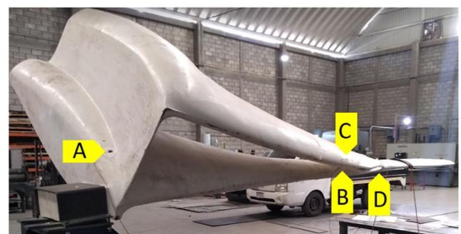
**Figura 15.** Galgas instaladas en el álabe para las pruebas a Flapwise.
