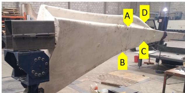
**Figura 16.** Galgas instaladas en álabe para pruebas a Edgewise.
