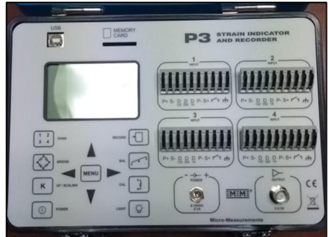
**Figura 14.** Indicador de tensión y registrador modelo P3.
