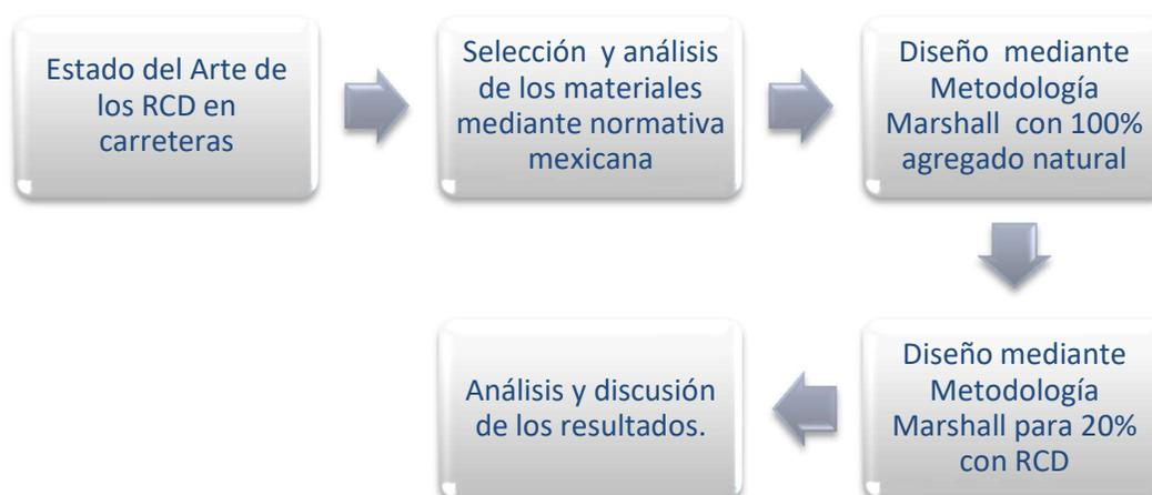
Figura 1. Metodología a seguir para el diseño de mezclas asfálticas.
