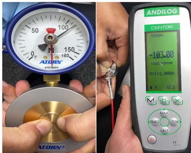
**Figura 1.** Manómetros de celda de carga o manómetros de presión.
