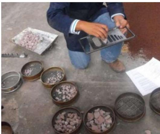
**Figura 4.** Partículas que pasan por el calibrador de espesores.
