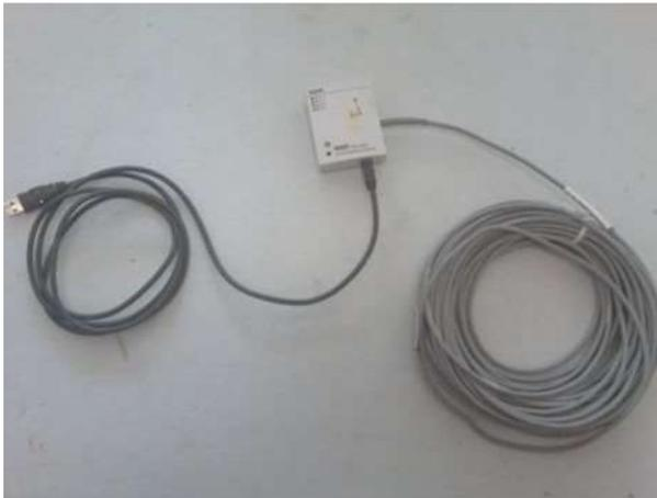
**Figura 4.** Datalogger U12 con canal externo.
