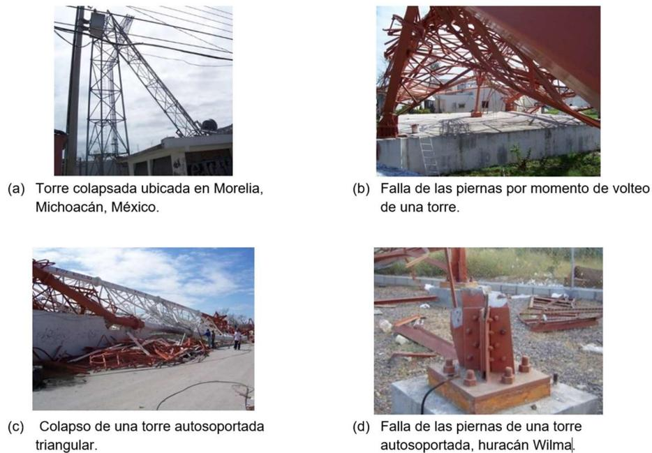
**Figura 6.** Fallas estructurales de torres de celosías autoportadas.
