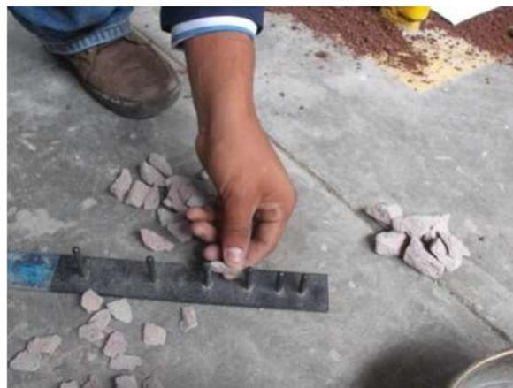
**Figura 5.** Partículas que no pasan por el calibrador de longitudes.
