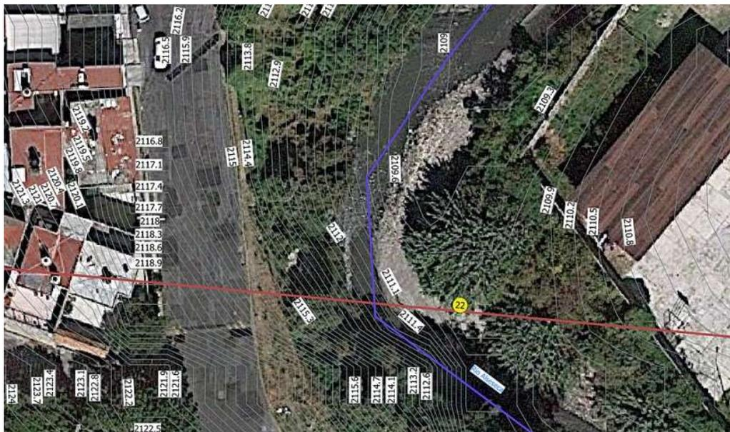
**Figura 7.** Curvas de nivel del corte transversal 22. Fuente: Modelo Digital de Elevación de Alta Resolución LiDAR, INEGI, 2012; Imagen satelital con resolución espacial de 10 cm, Universal Maps Downloader.
