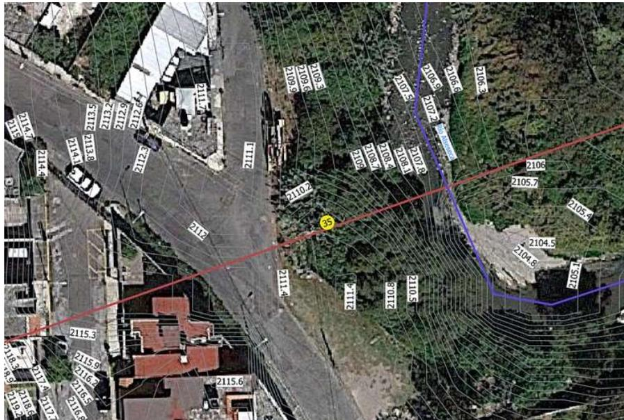
**Figura 9.** Curvas de nivel del corte transversal 35 de La Hacienda. Fuente: Modelo Digital de Elevación de Alta Resolución LiDAR, INEGI, 2012; Imagen satelital con resolución espacial de 10 cm, Universal Maps Downloader.
