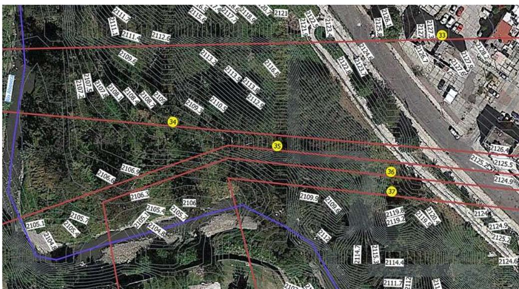
**Figura 10.** Curvas de nivel del corte transversal 35 de La Margarita. Fuente: Modelo Digital de Elevación de Alta Resolución LiDAR, INEGI, 2012; Imagen satelital con resolución espacial de 10 cm, Universal Maps Downloader.
