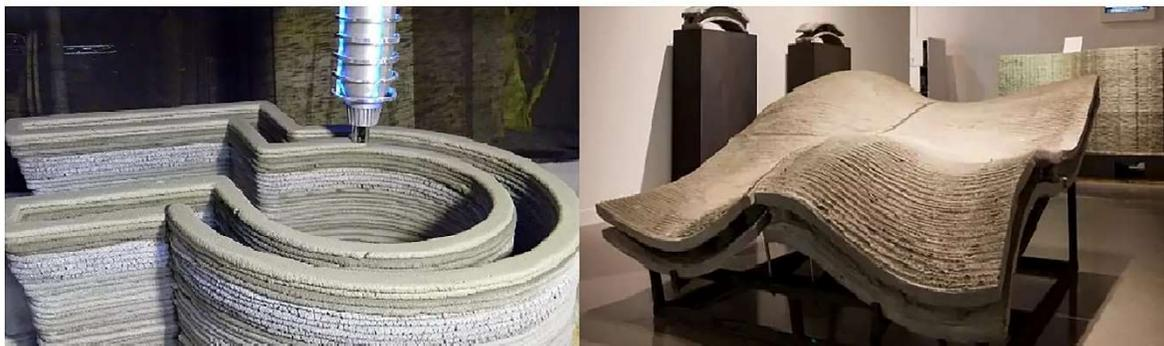
**Figura 5.** Proceso de impresión D-Shape. (Hamad, 2020).
