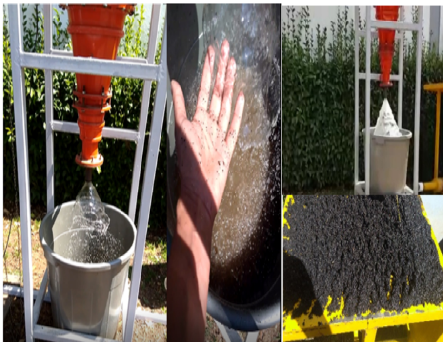
FIGURA 9. Funcionamiento de hidrociclón.
