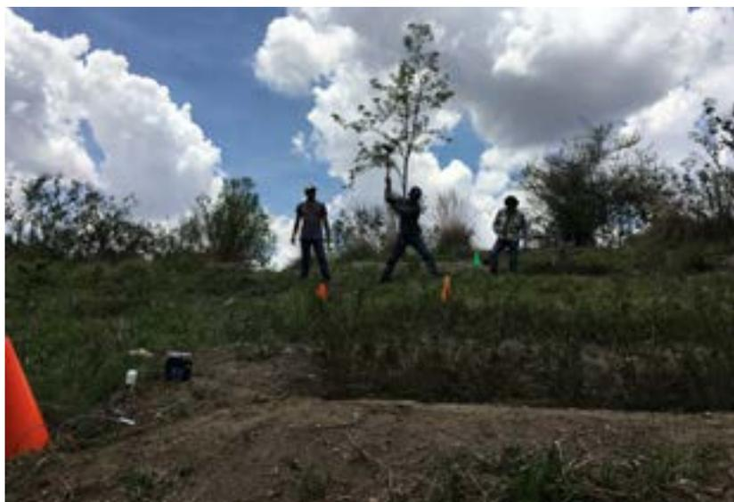
FIGURA 8. Utilización de marro como fuente de refracción sísmica convencional.
