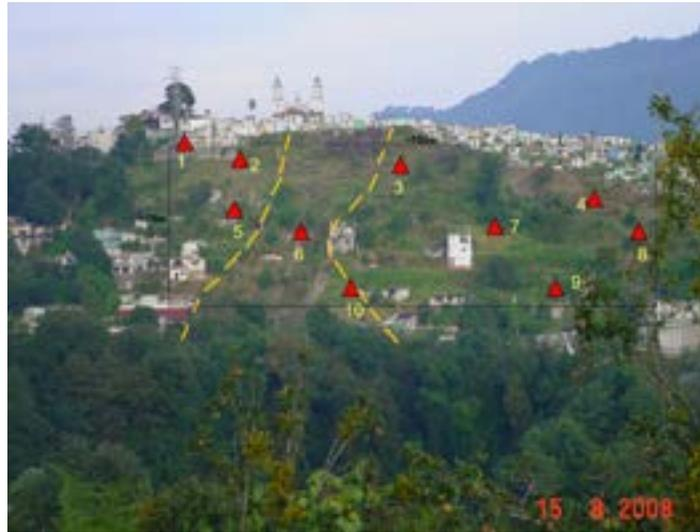
**FIGURA 3.** Puntos para prisma colocados en la ladera en la colonia La Aurora, Teziutlán. El cuadro en negro muestra el área de estudio y la línea punteada en amarillo indica el deslizamiento de octubre de 1999.
