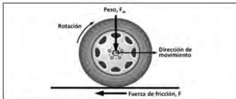
Figura 3. Diagrama de fuerzas actuando sobre el neumático Fuente: Lubis et al., 2018
