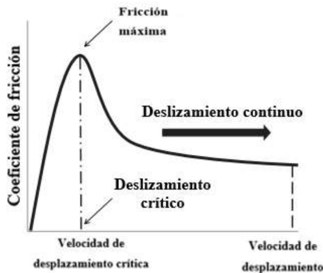
Figura 2. Comportamiento de la fricción del pavimento frente a la velocidad de deslizamiento Fuente: Iván et al. , 2012
