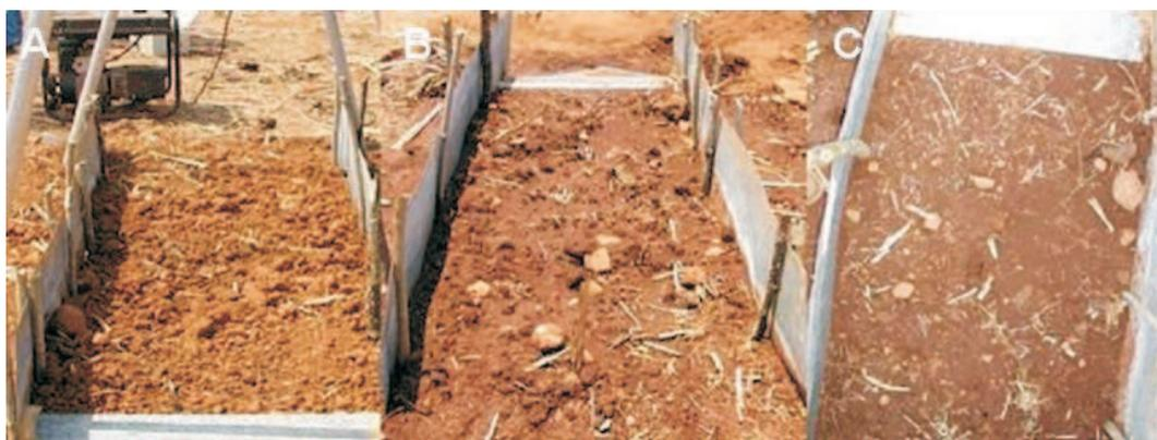
**Figura 4.** Cambios en la microtopografía de la parcela LB. (A) Antes de las simulaciones; (B) después de la primera simulación de 60 min; (C) después de la segunda simulación de 30 min.
