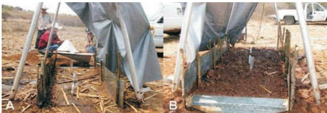
*Figura 3.* (A) Lote experimental para la condición sin roturación, y (B) Lote experimental para la condición con roturación.
