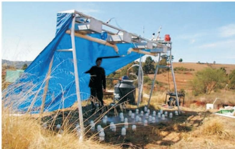
**Figura 2.** Simulador de lluvia tipo Purdue utilizado en las pruebas de campo.
