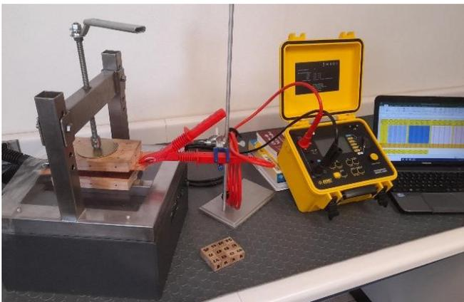
**Figura 3.** Pruebas de resistividad eléctrica.
