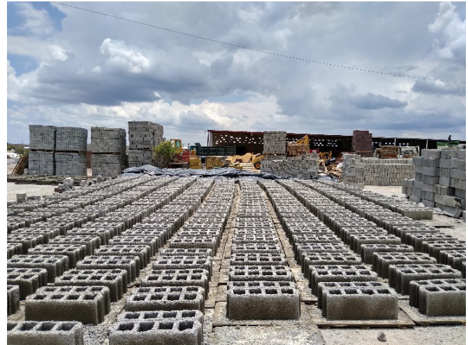
Figura 2. Curado tradicional de los tabicones pesados.
