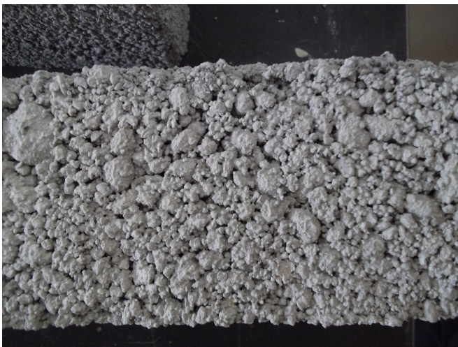
Figura 2. Textura del tabicón ligero empleando la dosis y granulometría tradicional.
