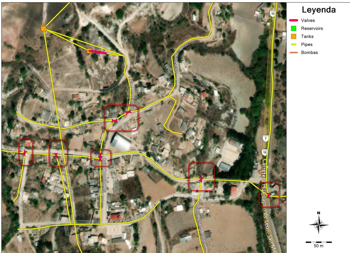
Figura 9. Ubicación de las válvulas en San Martín Sabinillo.
