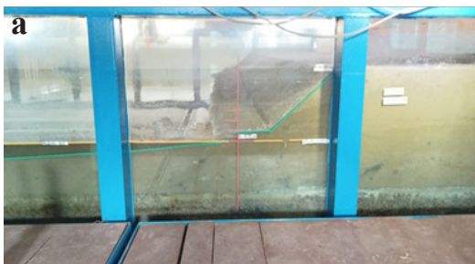
Figura 6. Resultados cambio del perfil de playa en los 16 puntos de control, con nivel del mar 0 m y periodo de 6.39 s.
