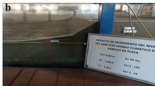
Figura 6. Resultados cambio del perfil de playa en los 16 puntos de control, con nivel del mar 0 m y periodo de 6.39 s.
