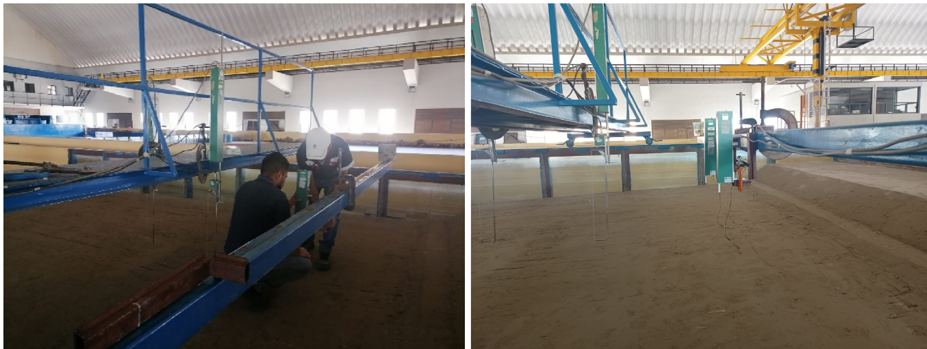
Figura 4. Sensores de medición de oleaje colocados durante los ensayos en modelo físico para el registro de las alturas de ola generadas.
