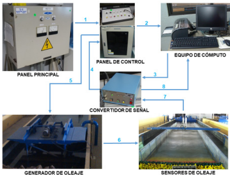
Figura 3. Equipo utilizado para la generación, medición y análisis de oleaje.
