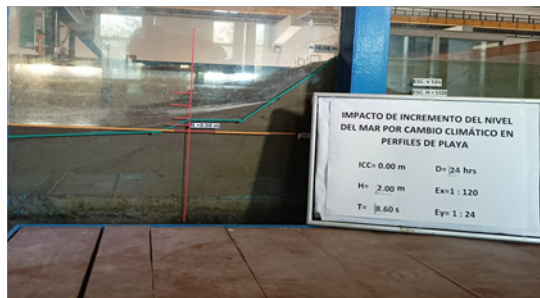
Figura 7. Resultados cambio del perfil de playa en los 16 puntos de control, con nivel del mar 0 m y periodo de 8.6 s.
