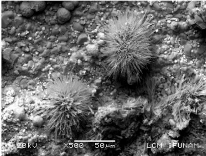
*Figura 5.* Microscopía Electrónica de Barrido (MEB): Agregados de colimaite con tamaño de 50 micrones.
