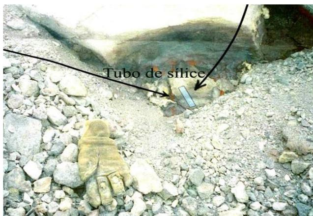
**Figura 4.** Muestreo en la zona fumarólica Z3 (T=700°-800°C) de los sublimados por medio de los tubos de sílice.
