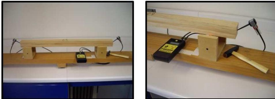
Figura 5. Pruebas de ondas de esfuerzo con el aparato *Fakkop*® en probetas de *P. pseudostrobus*.
