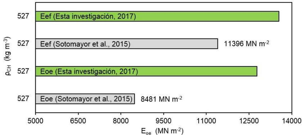
Figura 7. Comparación de los módulos efectivo ( $E_{ef}$ ) y dinámico ( $E_{oe}$ ) de esta investigación (2017) con los reportados por Sotomayor *et al.* (2015).
